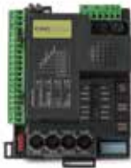
STARG824NG - COD. 12S021 Centrale di comando per motori 24 Vdc (senza trasformatore e box esterno)
