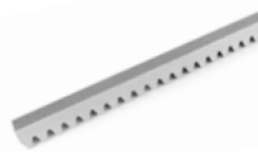
CRIS600 - COD. 162323 Cremagliera M6 30x30x1000 mm zincata, a saldare, da accoppiare alla corona M600
