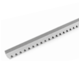
CRIS 600 Crémaillère m6 30x30x1000 mm zinguée, à souder, à accoupler à la couronne M600
